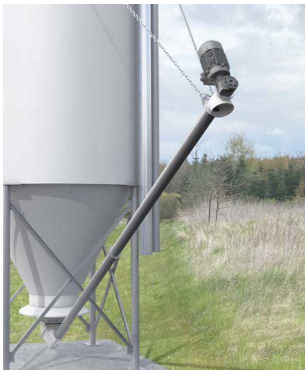
Transportskruv monterad på utomhussilo.
