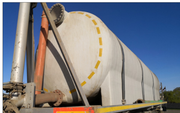
Rezervoarele pentru transportare pot fi montate pe remorci sau în containere deschise din oțel
