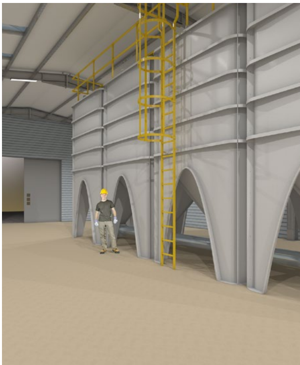
Ved sammenbygning af flere siloer leveres gangbro mellem siloerne.
