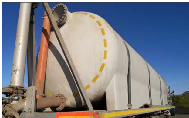
Transporttanken kan monteres på vogn eller i åben stålcontainer.
